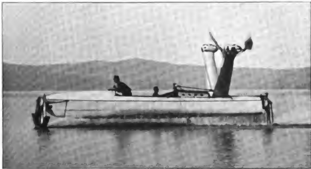
Hydroplan von Crocco und Ricaldoni auf dem See von Bracciano in voller Fahrt. (Der Rumpf ist vollständig aus dem Wasser.)
